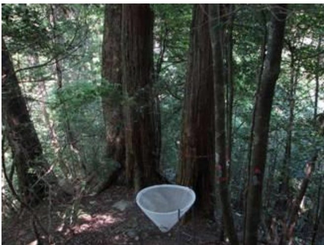
(写真) 市ノ又試験地の様子 落葉量を計測するために調査器具を設置しています。
